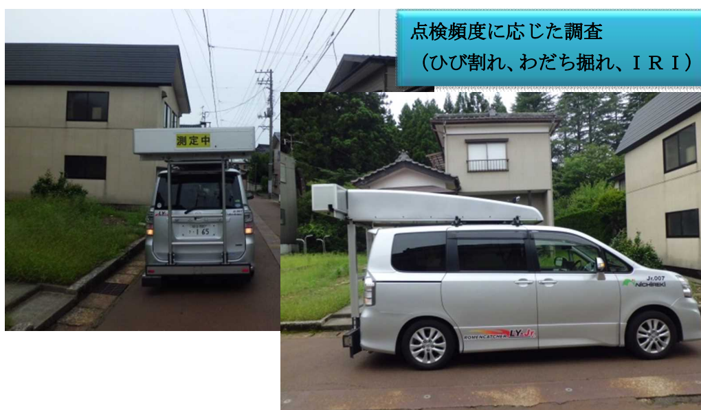
写真-3.1 路面性状測定車による点検
