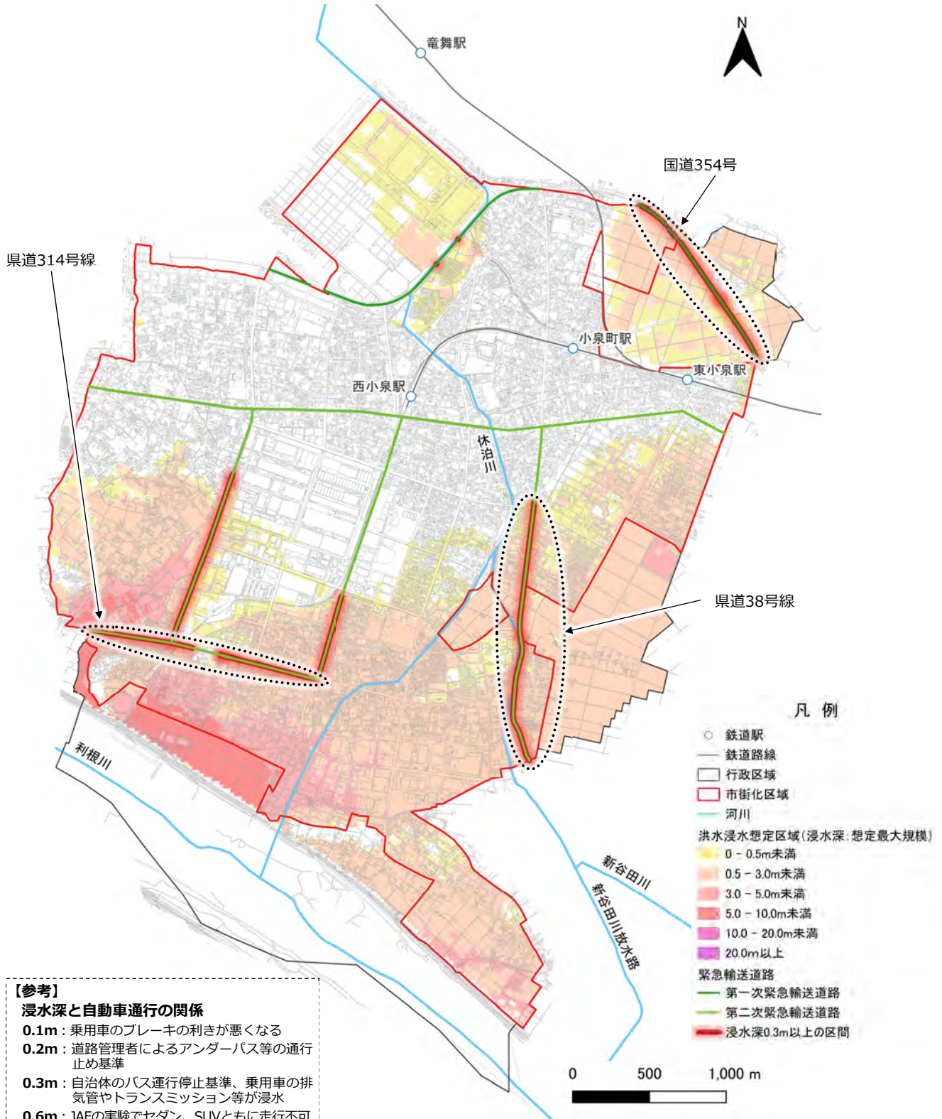
《 図7-40 洪水浸水想定区域(浸水深：想定最大規模 1/1000) × 緊急輸送道路 》
