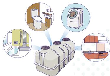
台所・お風呂・トイレの排水を処理する合併浄化槽は、トイレの排水を処理する単独浄化槽に比べ8倍水をきれいにする効果があります
