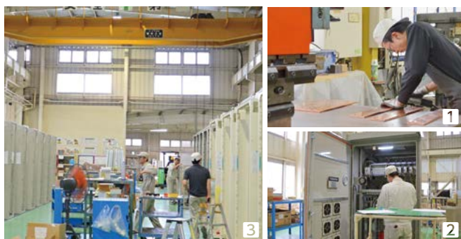
■ 1 高い精度が求められる導体加工 / 2 高い品質を保證する試験工程 / 3 組立と配線が同時に行われる工場内
