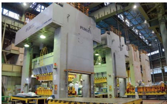
■大型プレス機による金型の試圧実験
