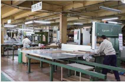
▲バーチカルカッターによる切断加工
