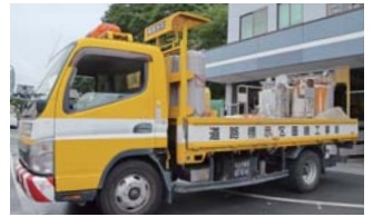
▲区画線の材料を溶かすための溶解窯を搭載した二台車
