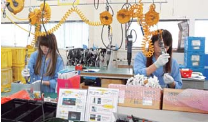
▲コントロールボックスの組立て
