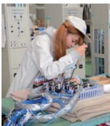
▲配電制御盤の組立作業の様子
