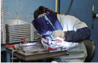
▲高い技術が必要なアルミ溶接
