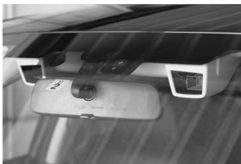
バックミラー近くに取り付けられている2台のステレオカメラ
