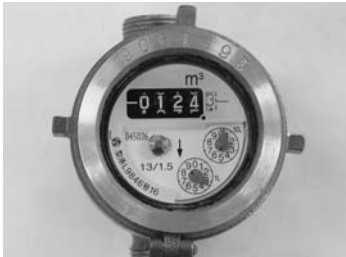
パイロットで漏水かどうか ご確認ください
